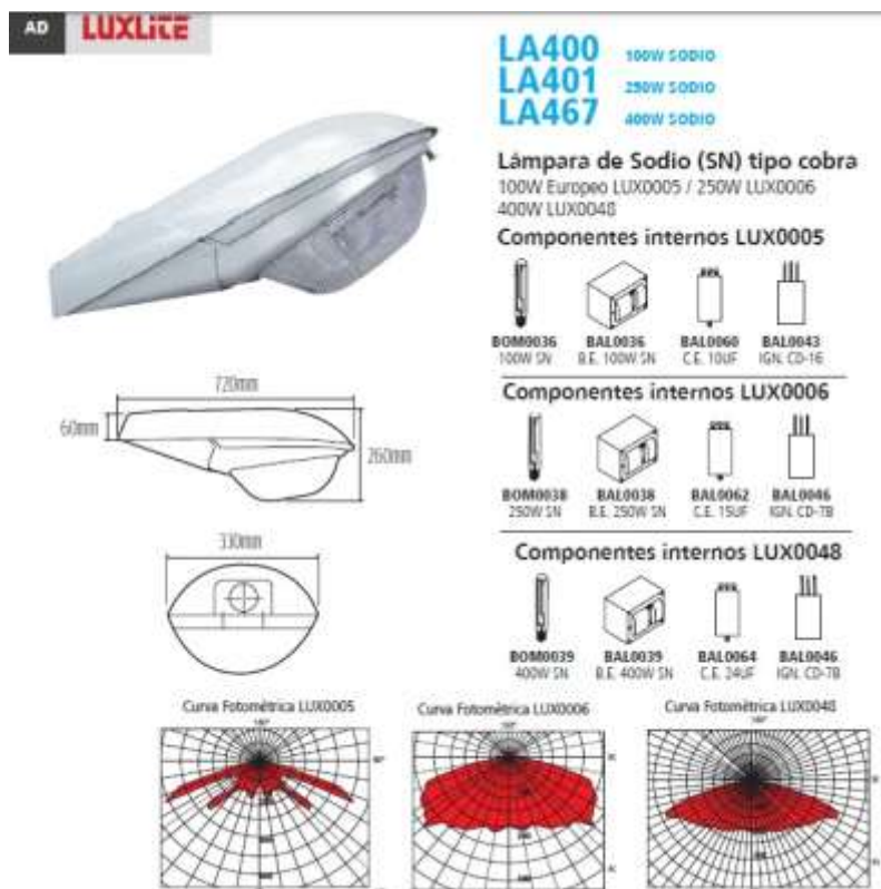
Figura No. 18 Luminaria tipo cobra con lámpara de sodio y sus componentes.
