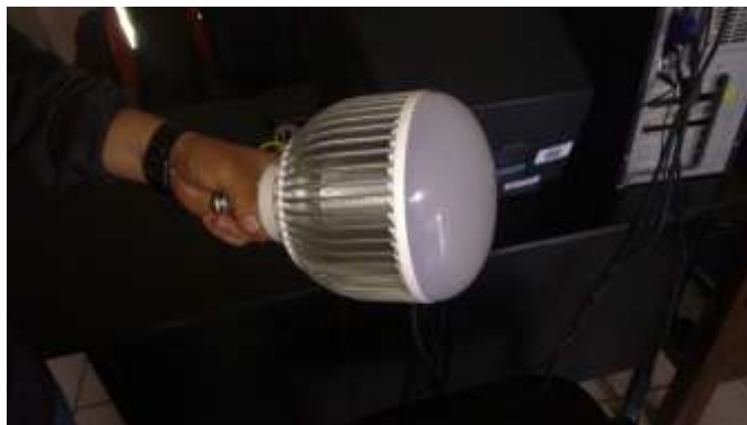
Fuente: municipalidad del municipio de La Esperanza, Departamento de Quetzaltenango; se puede observar una lámpara tipo Led que se utiliza para la luminaria de canasta.
