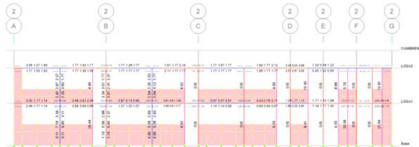
b) Acero requerido en elementos de concreto verticales (mochetas) fachada frontal modelo analítico etabs modulo EU-622 actual. Puede observarse varias columnas (mochetas) fallan debido a su condición de columna corta
