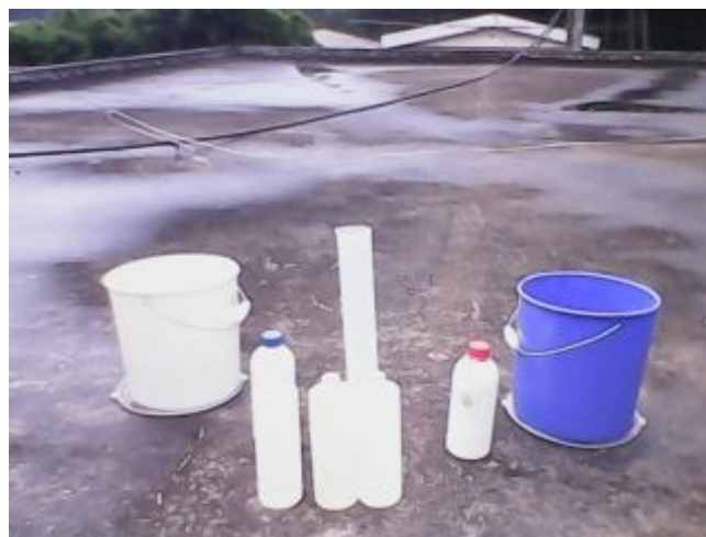
Figura 14. Ubicación de depósitos atmosféricos
