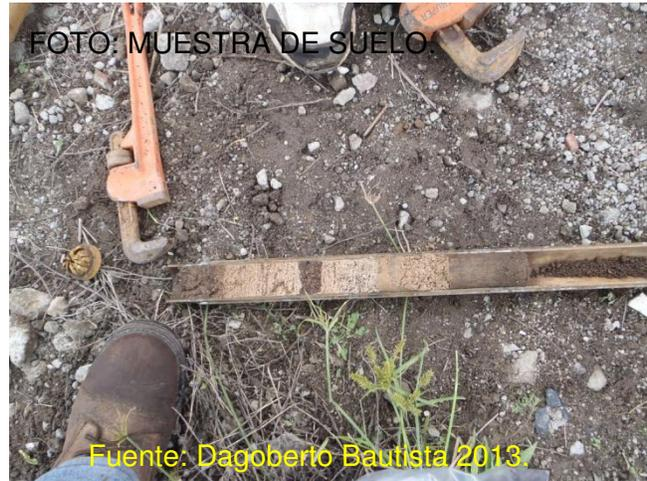
De 1.50 a 2.00 metros de profundidad la compacidad relativa es un suelo **medio denso** con porcentaje de humedad de 24.9, por ciento de humedad, PRESENTANDO UNA RESISTENCIA BAJA de 10.01 ton/mts<sup>2</sup>, SM:Arenas limosas, mezclas de arena y limo, el índice de plasticidad es de 0.
