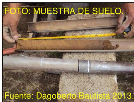
más elásticos. Y para el resto es CL: Arcillas inorgánicas de baja o media plasticidad, arcillas con grava, arcillas arenosas, arcillas limosas, arcillas pobres. El índice de plasticidad es de 0.
