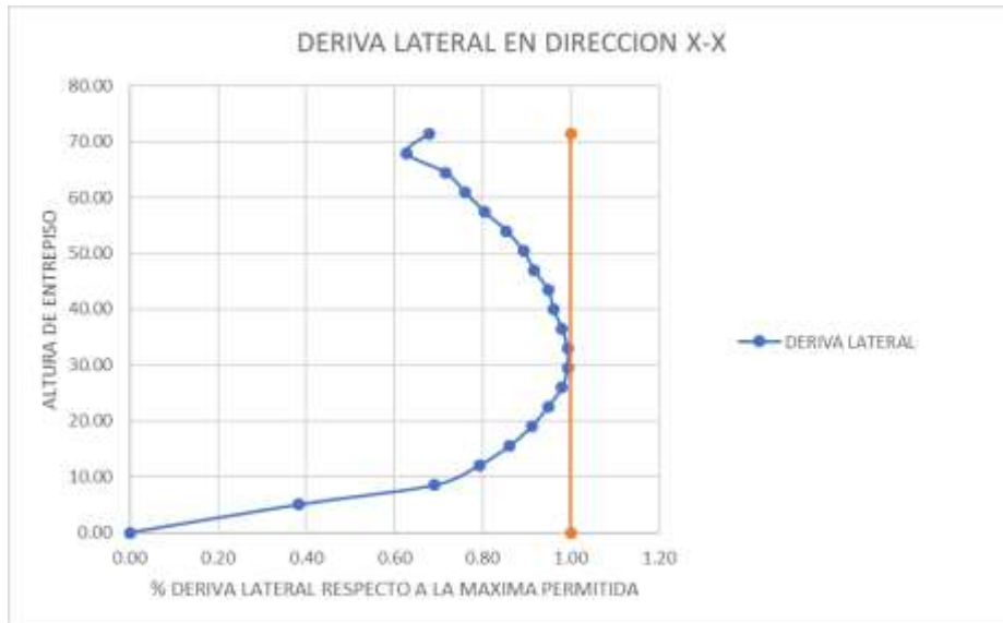
Figura 6 Deriva lateral sentido Este-Oeste al límite de cedencia con el sismo de diseño dinámico al 99% de la deriva lateral máxima permisible.
