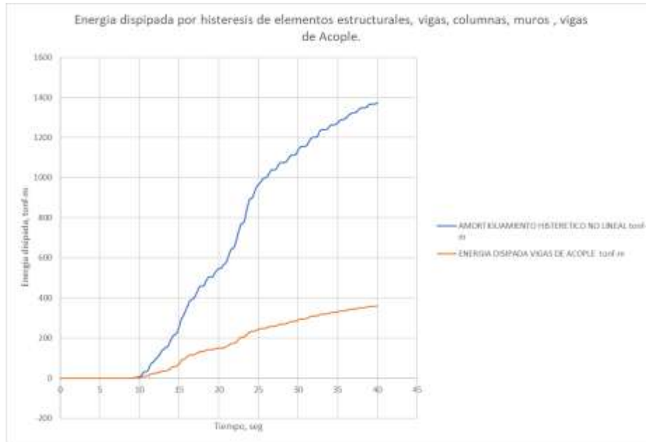
Figura 32 Energía disipada por comportamiento histerético no lineal.
