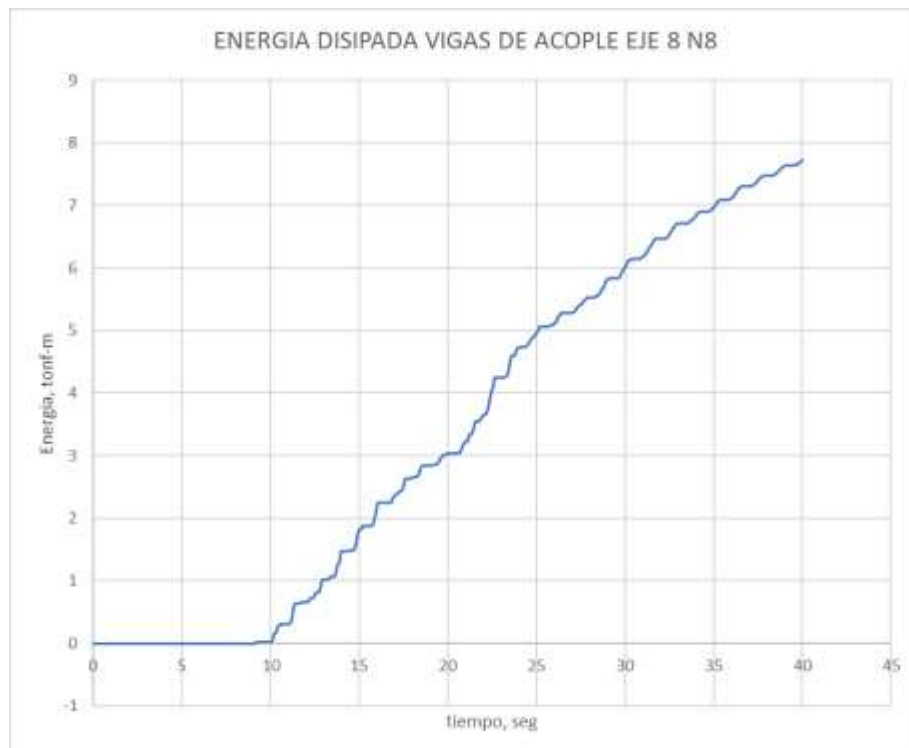
Figura 30 Energía disipada por Viga de Acople Eje 8 N8 = 7.93 Tonf-m.
